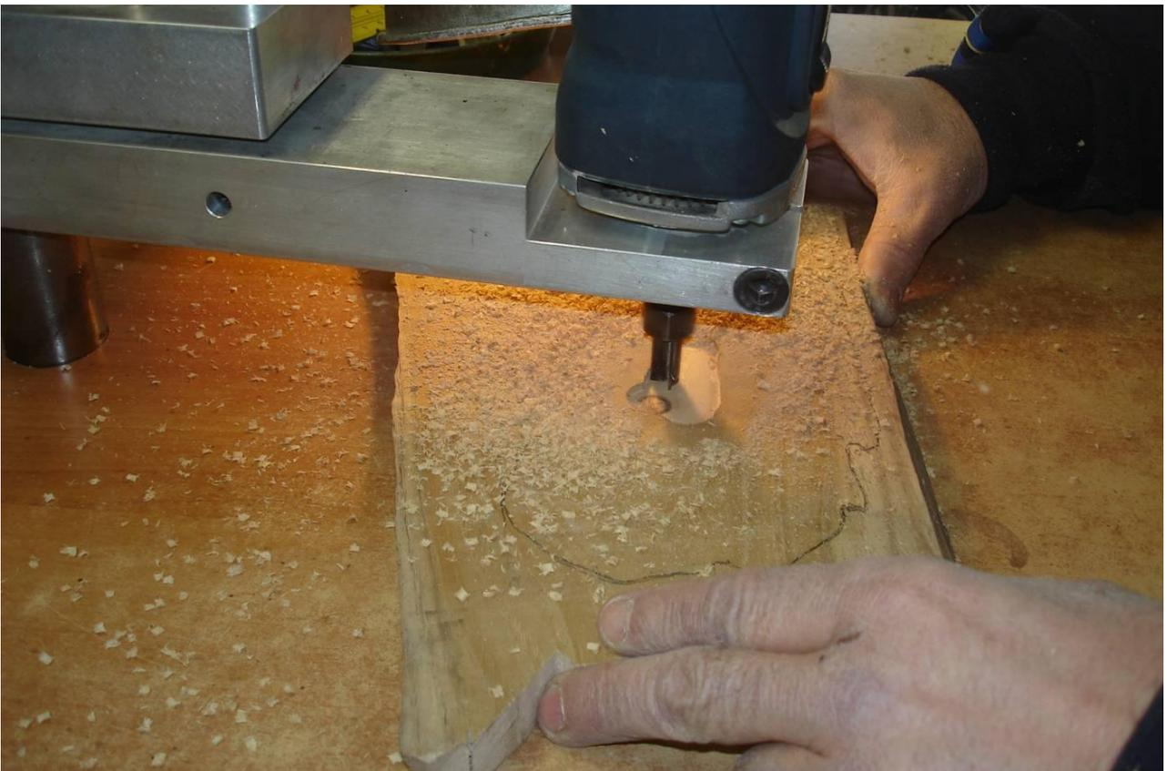
**3.2.2 Con fresa pantografo:** questo è il metodo che prediligo per asportare il 70-80% del materiale, le mani sono al sicuro entrambe lontane dall'utensile, l'asse tramite due viti è fissa sul regolo che a sua volta è bloccato nella morsa. Sul pantografo ho fissato un pezzo di pexiglass trasparente e più grande, per avere maggiore appoggio.
