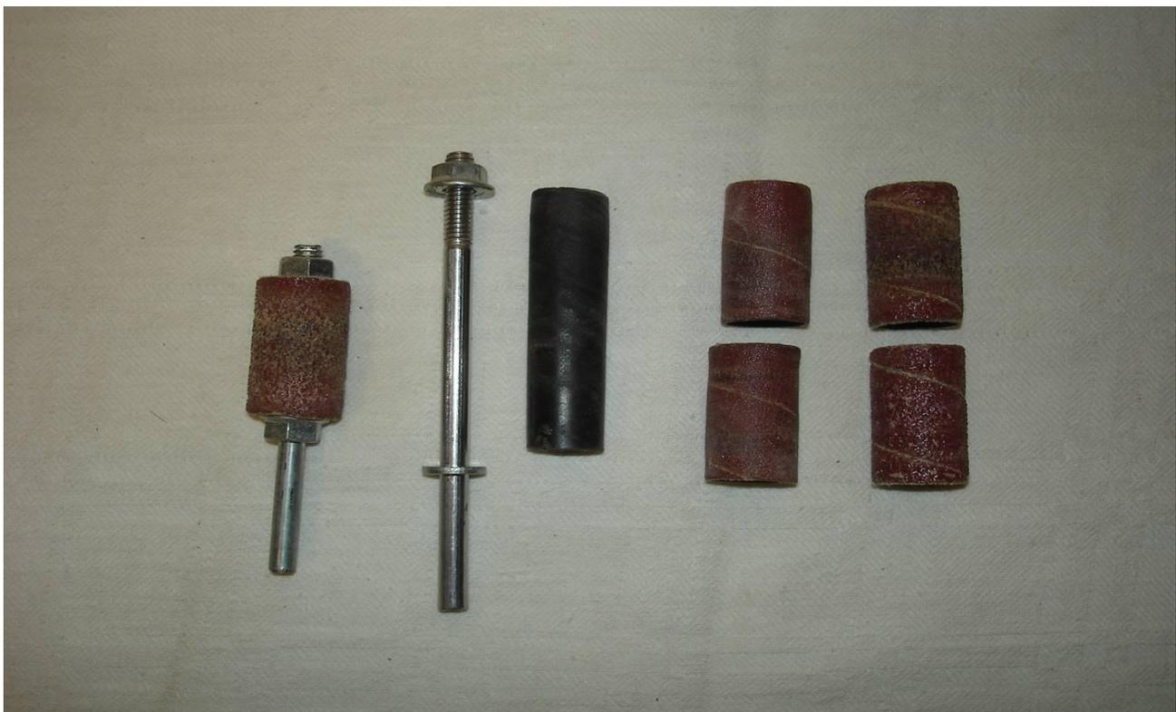
Parlando di rullino intendo un supporto con un inserto da sostituire quando usurato. Qui sopra un tipo di rullino semplice e uno doppio autocostruiti con un bullone da 6 mm, più o meno lungo, privo di testa, uno spezzone di gomma per aria compressore di lunghezza adeguata per uno o due inserti (la gomma ha il foro da 6mm ed entra di preciso nell'inserto), girando il dado con una chiave la gomma si "gonfia" e blocca l'inserto. Nella foto precedente rullini in commercio.
