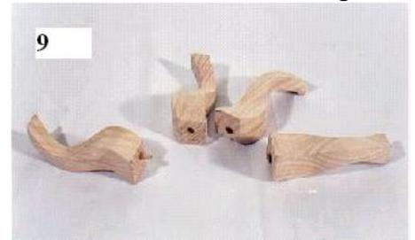
Incollare i piedini così come sono risulterebbero deboli e potrebbero staccarsi con facilità. Il metodo che io preferisco è quello di inserire un pernio di legno fra i due pezzi da incollare, in modo che sia molto difficile che si stacchino. Con una punta di 6 mm (il diametro del
